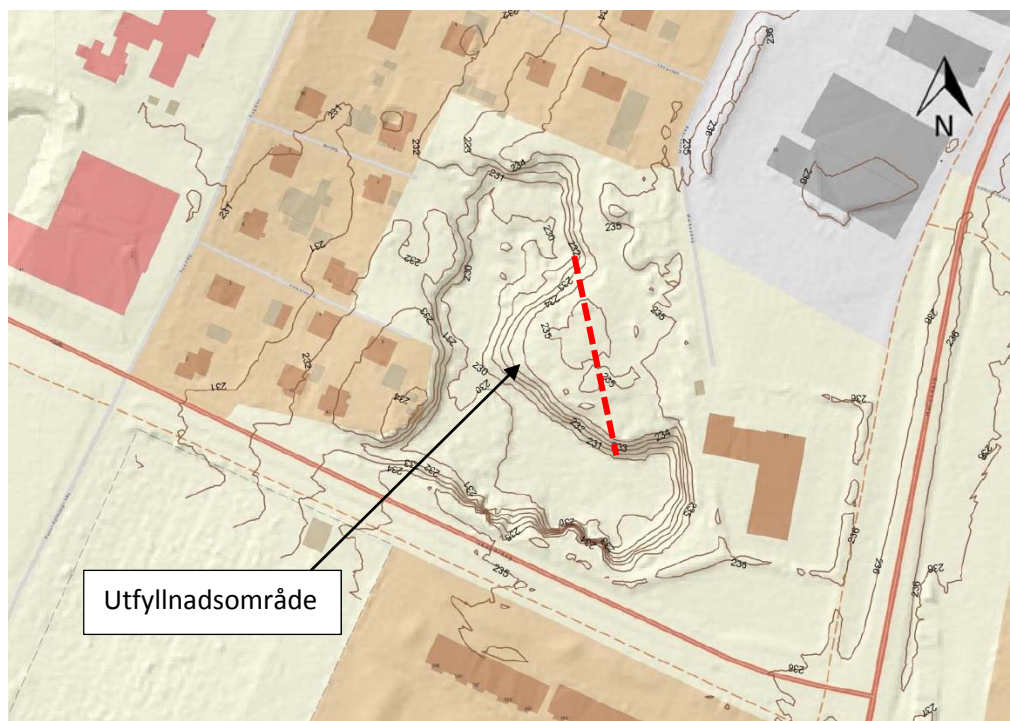
Figur 9. Topografisk karta över kalkbrottet (Falköping kommun). Röd markering är en projicering av klippväggens läge från figur ovan. Utfyllnad har därefter skett i västlig riktning.
